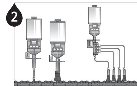
원포인트, 멀티포인트, 브러쉬키트 설치 시 환경에 맞는 액세서리 선택 후 설치합니다.
