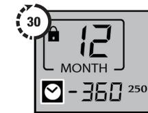
Nach dem Einschalten des Motors werden auf dem LCD Display innerhalb von 30 Minuten diese Symbole angezeigt.
