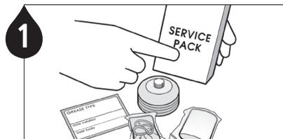
Überprüfen Sie die einzelnen Artikel des neuen Service Packs auf Vollständigkeit und Richtigkeit (Austauschbatterie, Fettbeutel, Staubschutzhülle, Etikett).
