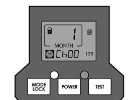
증상: LCD 문자불량(Segment 불량), LCD 부분 변색
