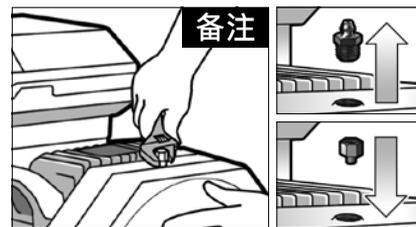
3 拧开油脂嘴 (Nipple) 接合相应变径接头
