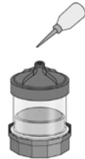
Füllen Sie Öl in die leere Einheit mit geeigneten Füllwerkzeug ein.
